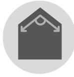
Questa icona indica il grado di inclinazione massimo per l'installazione del ventilatore su un soffitto inclinato.
